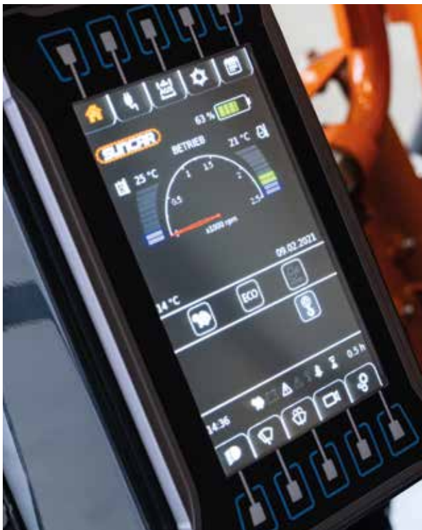
Multifunksjonsmonitoren betjenes via den ergonomisk plasserte smartkontrollen (dreihjulknapp).
