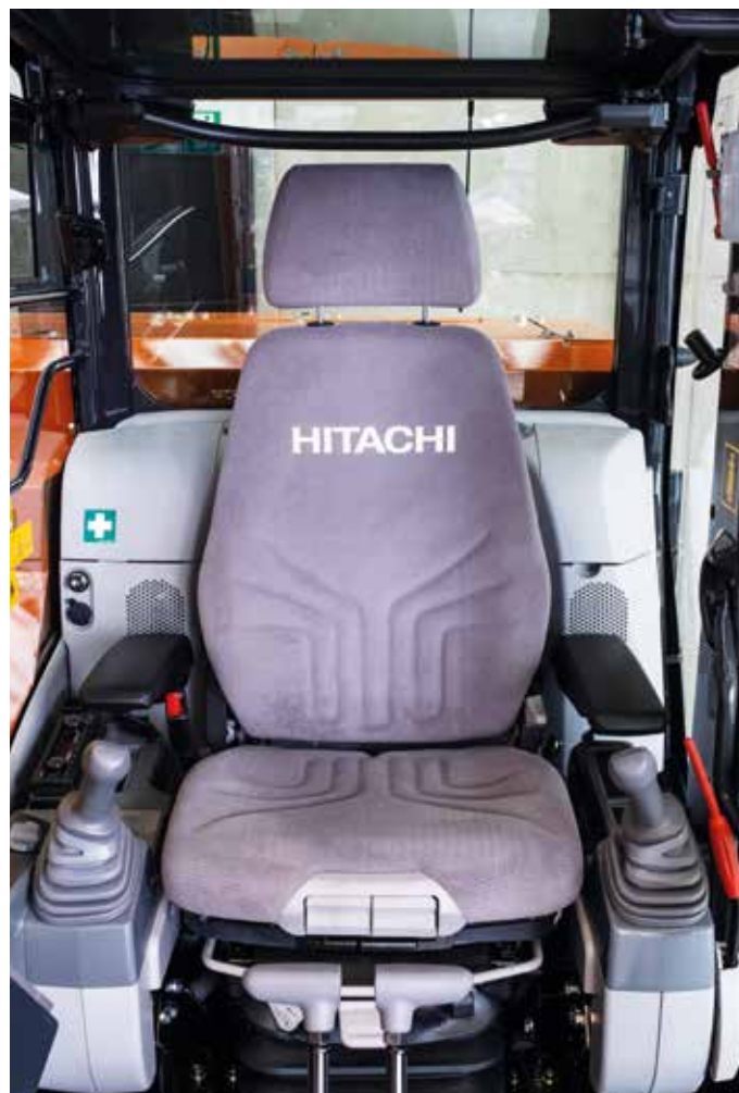
Grammer komfortsete med setevarme og luftfjærer kan flyttes for ekstra benplass.
