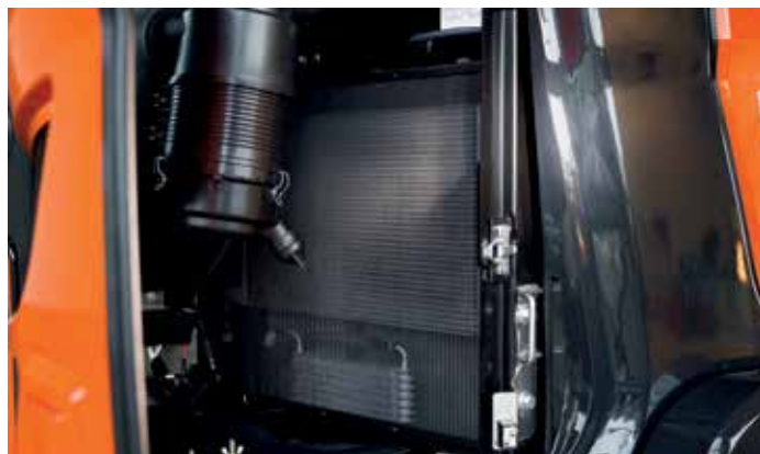
Radiatoren har god tilgang for rengjøring.
