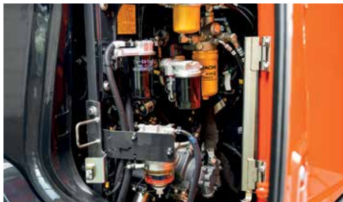
Alle filtrene er bekvemt plassert i ett rom.
