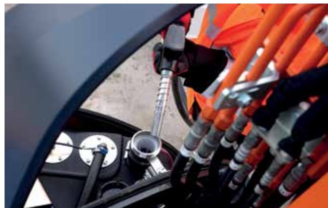
Drivstofftanken har fått ny plassering, slik at den kan fylles enklere og tryggere.
