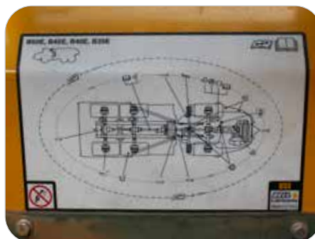
Det praktiske og lettfattelige RSG-dekalet viser daglige kontrollpunkter og respektive handlinger (f.eks. smøring).
