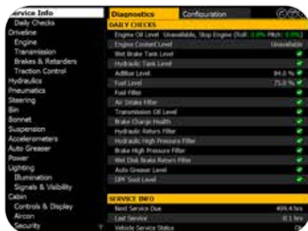
Enkel sjekk av nivåer i monitor
