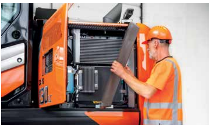
Større radiatordør (ZX130-7B) gir enkel adgang for rengjøring og vedlikehold.
