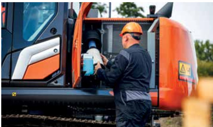
Tilgangen til filtre er forbedret på ZX135US-7B.
